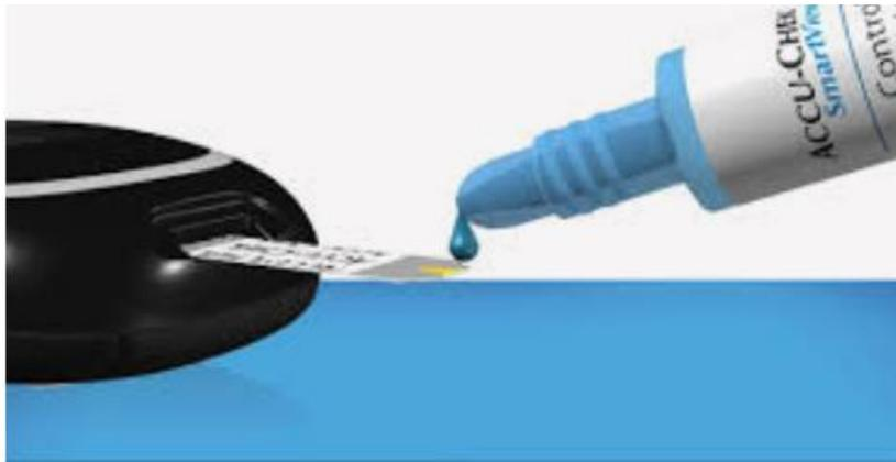
將監控液水滴靠近試條末端，請避免直接接觸監控液樽尖端，以防止污染。
